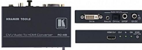
Le FC-49 est un embeddeur et convertisseur de format de haute qualité pour signaux DVI et audio. Il convertit un signal DVI et embedde un signal audio stéréo asymétrique ou S/PDIF ou TOSLINK® vers une sortie HDMI.
